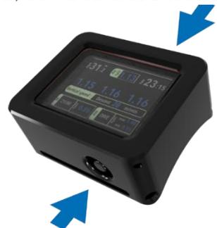
FIGURE 2.4 – Vue de l'afficheur de PpO<sub>2</sub>
